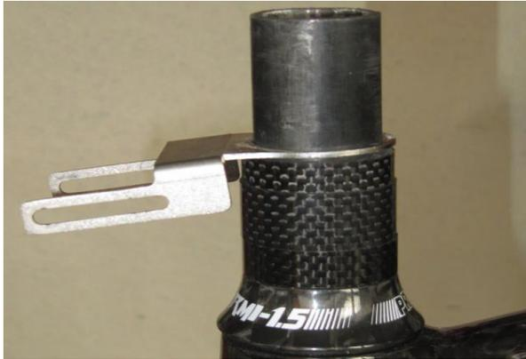
4. Montieren Sie nun wie gewohnt den Vorbau. Ziehen Sie die Schrauben noch nicht an. Biegen Sie das Montageblech so, dass es parallel zur Achse des Vorbaus steht.
