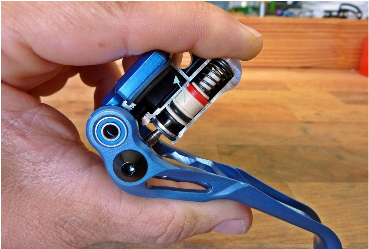
Im folgenden Schritt wird das Entlüften des Sekundärtraumes der Bremspumpe beschrieben. Da aus Platzgründen auf eine zusätzliche Bohrung zwischen Sekundärtraum und Ausgleichsbehälter verzichtet werden musste, ist dies ein tragender Schritt für eine saubere Entlüftung.
