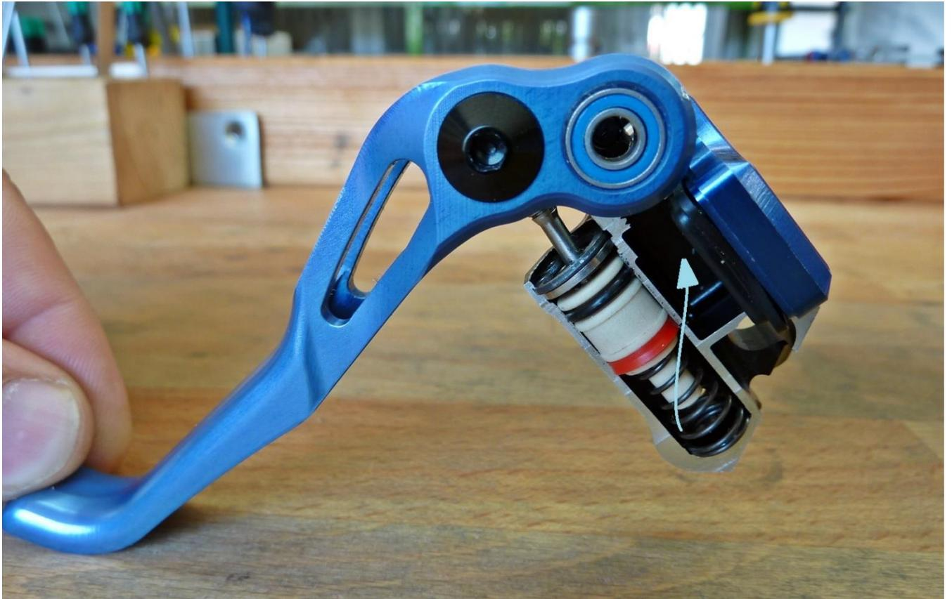
Halten Sie nun die Bremspumpe in gezeigter Position und ziehen/drücken Sie mehrfach an der Spritze. Die Schnüffelbohrungen bilden so den höchsten Punkt des Hochdruckraumes – etwaige Luft im Hochdruckraum wandert so in den Ausgleichsbehälter und damit in die Spritze.
