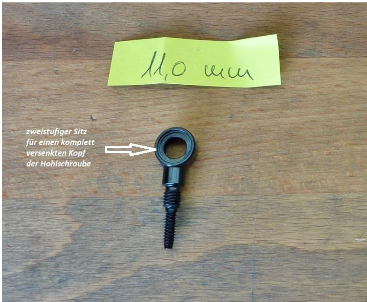
Bild 3: Zweistufiger Ringanschluss auf der Einführseite der Hohlsschraube. 11,0 mm Außendurchmesser.
