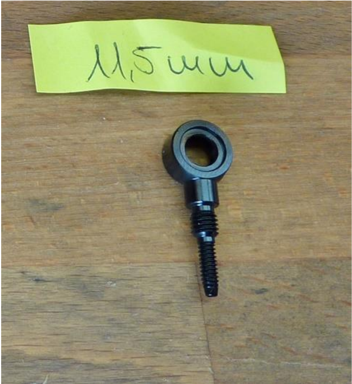
Bild 5: Einstufiger Ringanschluss mit 11,5 mm Außendurchmesser.
