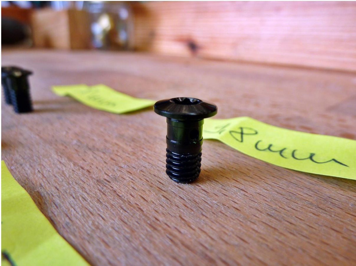
Bild 4: Einschnürung auf Höhe der Querbohrung. 9,8 mm Kopfaußendurchmesser.
