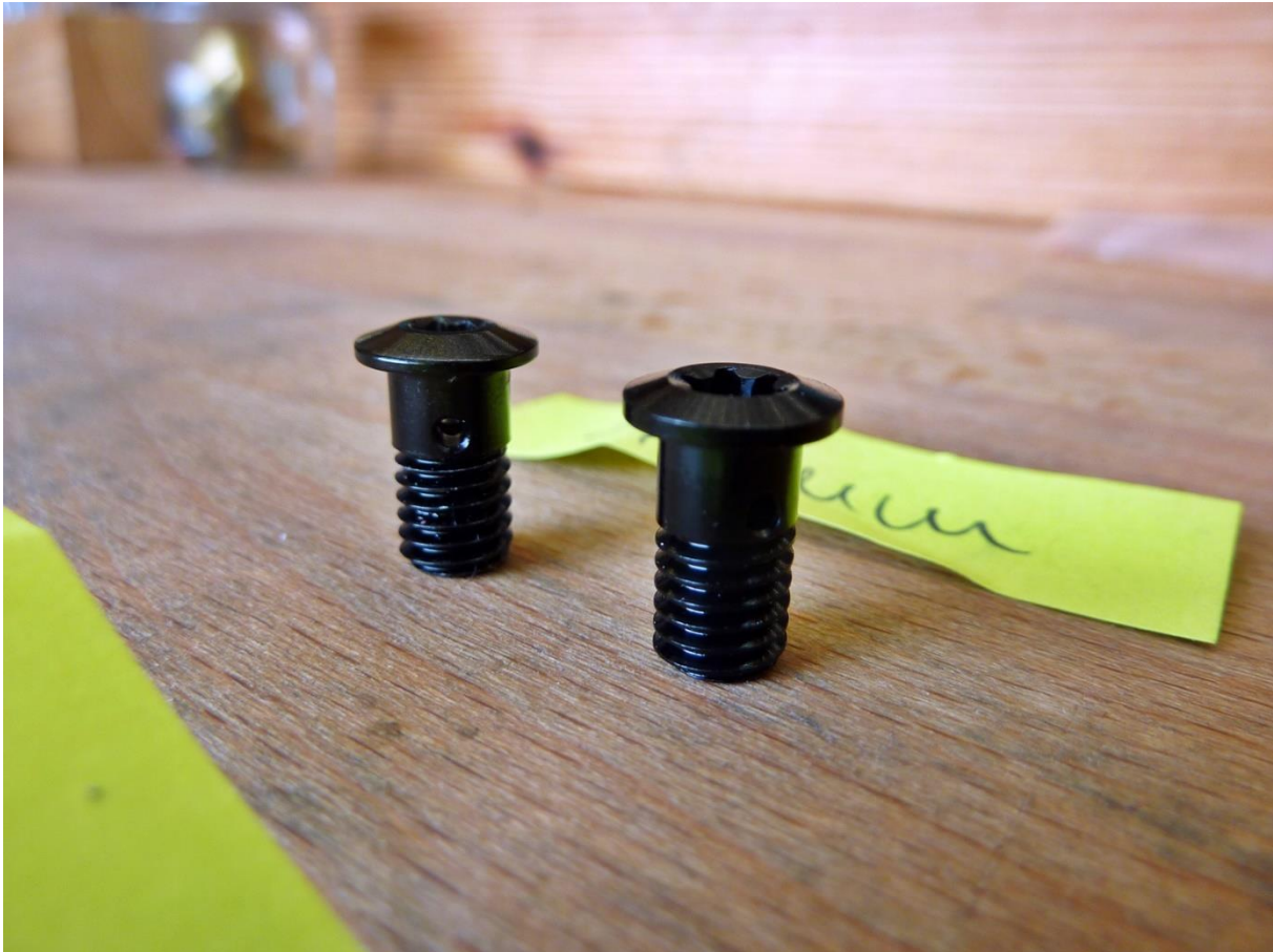
Bild 2: Keine Einschnürung auf Höhe der Querbohrung. 8,8 mm Kopfaußendurchmesser.
